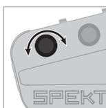
Faites tourner le potentiomètre ST RATE dans le sens anti-horaire pour réduire la sensibilité.
