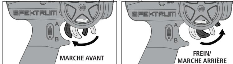
5. Poussez le déclencheur de l'émetteur sur plein frein, arrêtez, puis remettez le déclencheur au centre.
