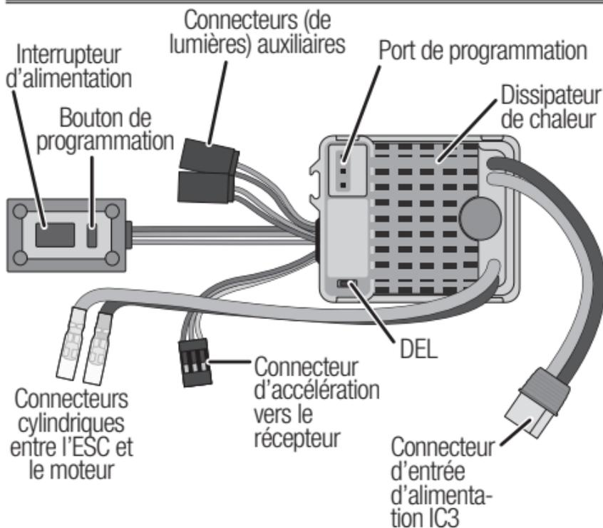
**REMARQUE :** Débranchez toujours la batterie du variateur ESC lorsque vous avez terminé d'utiliser votre véhicule. Si vous laissez la batterie connectée avec l'interrupteur d'alimentation en position OFF, le variateur ESC continue de tirer du courant lorsqu'il est branché à la batterie ; celle-ci pourrait alors s'endommager par décharge excessive.
