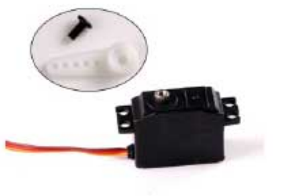
FMS-Servo-25g metal digital
