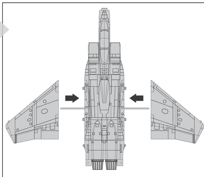
3. Mithilfe eines 2-mm-Sechskants die 4-M3x10 Flachkopfschrauben zum Sichern der Tragflächen des Hauptflügels montieren.
