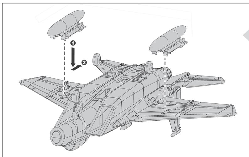
2. Auf jedem Flügel einen Geschossaufbau befestigen, indem diese in den Schlitz gesteckt und zur Sicherung nach hinten geschoben werden. Sicherstellen, dass der lange Bereich des Tanks nach vorne zeigt. Kein Klebstoff erforderlich.
