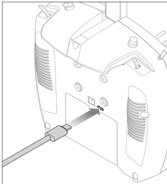
5. Der Ladevorgang ist abgeschlossen, wenn die LED und die LED-Streifen erlöschen, die Taste gedrückt wird und das Symbol für die Akkukapazität auf dem Bildschirm voll angezeigt wird. Sobald der Ladevorgang abgeschlossen ist, ziehen Sie das USB-Kabel vom Sender ab. Das Netzteil von der Steckdose trennen.
