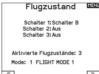
Sie können bis zu zehn Flugmodi mit einer beliebigen Kombination von bis zu drei Schaltern zuweisen. Die maximale Anzahl der verfügbaren Flugmodi und Schalter hängt vom Modelltyp ab. Sehen Sie sich die Optionen je nach Flugzeugtyp in der Tabelle unten an. Im Modus Segelflugzeug können Sie auch einen Prioritätsschalter zuweisen. Wenn die Position des Prioritätsschalters aktiv ist, ist nur der aktuelle Flugmodus aktiv, unabhängig von anderen Schalterstellungen.
