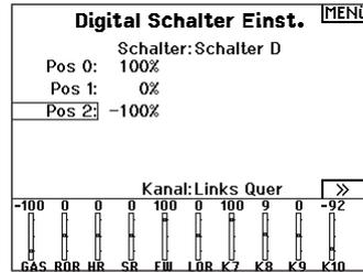
**WICHTIG:** Nachdem Sie das Einstellmenü verlassen haben wird oben im Menü AUS angezeigt. Sollten Sie den gerade eingestellten Wert ändern wollen, wählen Sie den Schalter und die eingegebenen Werte werden angezeigt und können geändert werden.
