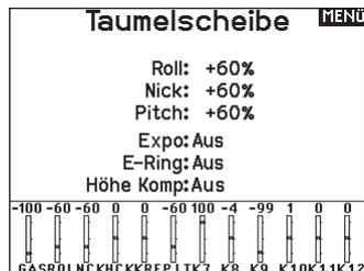
Aktivieren Sie bei Einsatz eines Servo mit Standardarm immer die Expofunktion. Die Expofunktion erzeugt eine lineare Bewegung eines drehenden Servos. Ist diese Funktion ausgeschaltet bewegt sich der Arm in einer Kurve, was zu verringerten Ausschlägen im Endbereich des Servoweges führt.
