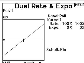
Die Exponentialfunktion beeinflusst die Mittensensitivität, hat aber keinen Einfluß auf den Servoweg. Es sind positive und negative Exponentialwerte möglich. Ein positiver Wert verringert die Sensitivität in der Mittenstellung. Ein negativer Wert erhöht die Sensitivität und wird selten genutzt.
