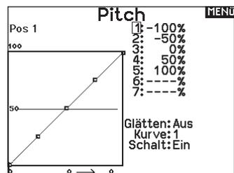
3. Weisen Sie den Pitch-Kanal in der Funktion Channel Assignment [Kanalzuordnung] zu, nachdem Sie die Funktion Pitch Curve aktiviert haben.
