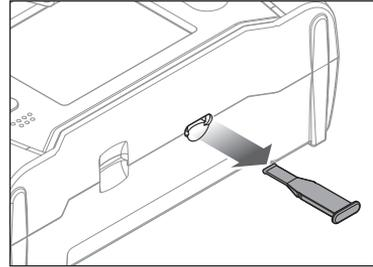
**WICHTIG:** Drehen oder hebeln Sie niemals seitlich am Sicherungstool. Andernfalls kann das Werkzeug im Slot abreißen.
