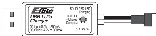
**AVVISO:** caricare le batterie solo se sono fredde al tatto e non sono danneggiate. Verificare che le batterie non siano danneggiate, ad esempio gonfie, piegate, rotte o forate.
