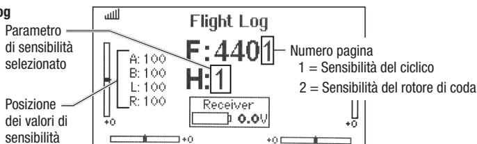
Dopo essere entrati nella modalità di regolazione della sensibilità (Gain), muovere lo stick del ciclico a destra e a sinistra per scegliere il parametro di sensibilità da regolare. Muovendo lo stick a destra si sceglie il parametro successivo, muovendolo a sinistra si sceglie quello precedente. Il parametro di sensibilità selezionato viene indicato nella schermata "Flight Log" sopra e in dipendenza del piatto ciclico sull'asse di rollio come illustrato nella tabella qui a destra.
