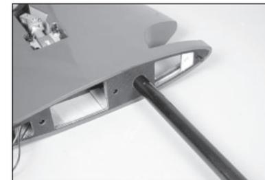
144. Faites glisser le tube dans le fuselage de l'aile. Connectez les câbles pour les ailerons et les volets aux rallonges. Guidez les câbles de la rentrée et du frein dans le fuselage.
