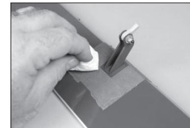
26. Posez les charnières des ailerons en utilisant la même technique que celle décrite pour les charnières des volets. Assurez-vous que l'aileron est bien aligné avec le volet.
