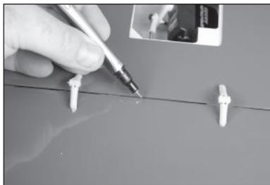
58. Positionnez le guignol de commande du volet sur la partie plate du volet, centré avec le repère marqué à l'étape précédente. Faites glisser le guignol de commande du volet vers le bas du volet avec la partie plate du guignol de commande orientée vers le bas de l'aile. Utilisez un stylo-feutre pour marquer les emplacements des vis de montage du guignol de commande du volet.
