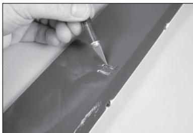
13. Poncez légèrement l'emplacement des guignols de commande d'aileron là où ils s'insèrent dans l'aileron. (Les guignols de commande d'aileron sont les plus long fournis.)
