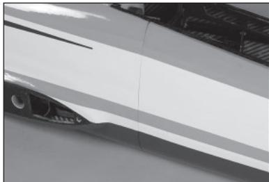
140. Fixez la section du fuselage à l'aide des cinq vis préparées précédemment. Serrez les vis à l'aide d'une clé à six pans de 3 mm.
