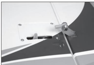
77. Assemblez la tringlerie du servo de gouverne de direction. Utilisez une tige filetée de 35 mm et ajustez la tringlerie à une longueur totale de 65 mm. Ajustez la longueur de la tringlerie si nécessaire pour centrer la gouverne de direction avec le système radio en marche.
