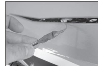
132. Préparez un mélange de 15 ml (1/2 once) de colle époxy 30 minutes. Utilisez un pinceau à époxy pour appliquer la colle dans les tubes du fuselage pour la dérive et sur le bois environnant.
