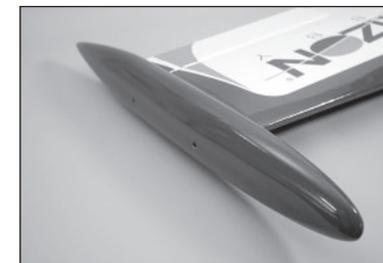
152. Utilisez un couteau et une lame n° 11 pour retirer l'entoilage de l'antenne VOR dans la dérive. Collez l'antenne à la dérive avec de la colle cyanoacrylate. Utilisez une équerre pour vous assurer que l'antenne est correctement alignée des deux côtés de l'aileron.
