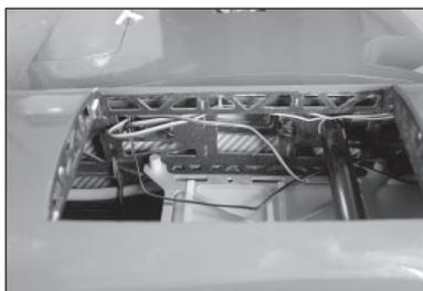
147. Connectez les câbles de la rentrée et du frein à l'intérieur du fuselage.
