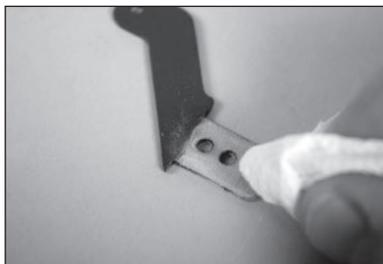
15. Testez l'ajustement des guignols de commande de l'aileron. Ils doivent s'insérer complètement dans la fente, comme illustré. Si ce n'est pas le cas, utilisez une lime pour agrandir la fente. Ne forcez pas le passage du guignol.
