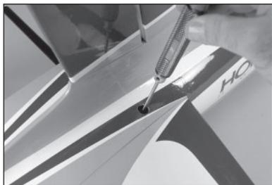
136. Insérez le silent-bloc de la vis du stabilisateur en utilisant une petite quantité de colle silicone.
