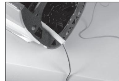
123. Faites glisser les manchons d'acheminement des servos aussi loin que possible. Marquez les manchons au niveau de la cloison pour vérifier le positionnement avant chaque session de vol. Utilisez des colliers de serrage pour fixer les manchons à la structure au-dessus de l'emplacement du tube de poussée afin qu'ils n'entrent pas en contact avec le tube d'échappement au cours de l'utilisation de votre modèle.
