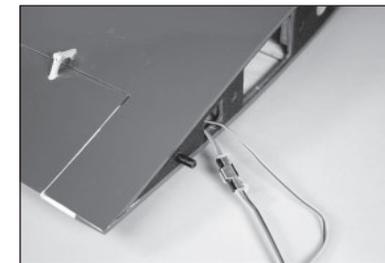
54. Centrez le servo à l'aide du système radio. Placez le bras du servo sur le servo de façon à ce qu'il soit placé une cannelure en avant vers le bord d'attaque de l'aile.
