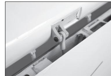
64. Ajustez la tringlerie de manière à ce que les volets soient en position intermédiaire de 25 mm (1 po).
