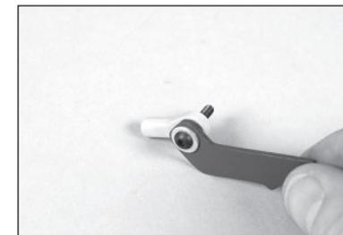
19. Faites glisser le guignol de commande restant sur la vis mécanique à tête bombée M3 x 15. Fixez l'ensemble à l'aide d'une rondelle M3 et d'un contre-écrou M3.
