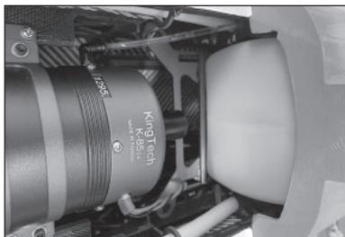
130. Montez la pompe à carburant dans le fuselage et raccordez toutes les conduites de carburant nécessaires au fonctionnement de la turbine. Raccordez la ligne d'évent à partir du réservoir. Fixez tous les branchements à l'aide de serre-câbles.
