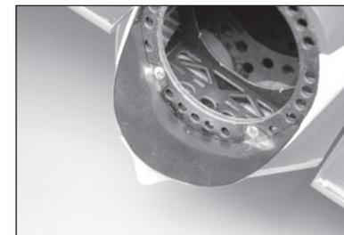
125. Faites glisser le tube d'échappement dans le fuselage arrière depuis l'avant du fuselage.
