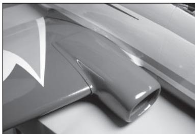
149. Utilisez un porte-foret et une mèche de 1,5 mm (1/16 po) pour percer les emplacements du système d'admission dans l'aile. Retirez le système d'admission et vissez une vis autotaraudeuse M2 x 8 dans chaque trou. Retirez les vis et appliquez une goutte de colle cyanoacrylate fine dans chaque trou. Une fois que la colle cyanoacrylate a complètement séché, fixez le système d'admission à l'aile à l'aide de douze vis autotaraudeuses M2 x 8.
