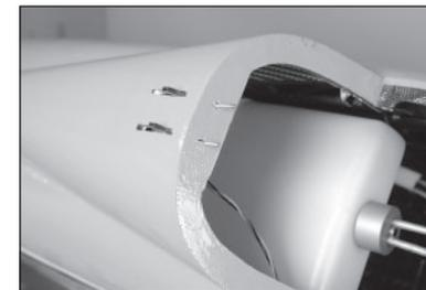
142. Mettez la trappe de la verrière en position sur le fuselage.
