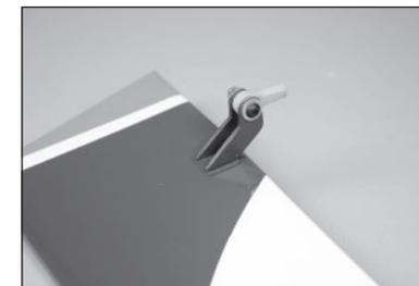
73. Lors de l'installation des charnières de la gouverne de direction, veuillez noter que la charnière inférieure a été raccourcie afin de pouvoir être placée derrière le tube de la tige de dérive.
