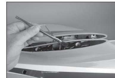
133. Fixez la dérive en position. Placez un petit morceau de plastique dans la ligne de charnière et le long du bas de la dérive pour éviter de coller la gouverne de direction au fuselage. Retirez tout l'excédent de colle époxy avec du papier absorbant imprégné d'alcool isopropylique.
