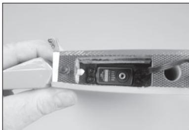
80. Assemblez la tringlerie du servo de la gouverne de profondeur en suivant les instructions de l'installation du servo de l'aileron. Utilisez une tige filetée de 40 mm et ajustez la tringlerie à une longueur totale de 65 mm. Ajustez la longueur de la tringlerie si nécessaire pour centrer la gouverne de profondeur avec le système radio en marche.
