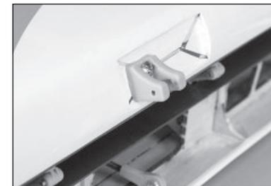
63. Fixez l'articulation à bille au guignol de commande des volets à l'aide d'une vis mécanique M3 x 15 et d'une rondelle M3. Utilisez une clé à six pans de 2 mm pour serrer la vis.
