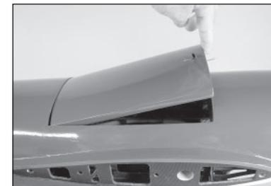
**111.** Retirez la trappe de la partie supérieure du fuselage arrière et mettez-la de côté dans un endroit sûr.
