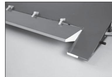
65. Réglez la course sur l'émetteur en position de volets relevés. Réglez les valeurs sur l'émetteur pour aligner le volet sur le bord d'attaque de l'aile.
