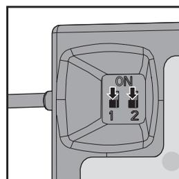
**Standardeinstellung** für den im Lieferumfang enthaltenen DX5e Sender mit 3-Positions Kanal 5 Schalter der die drei SAFE Modes schaltet.
