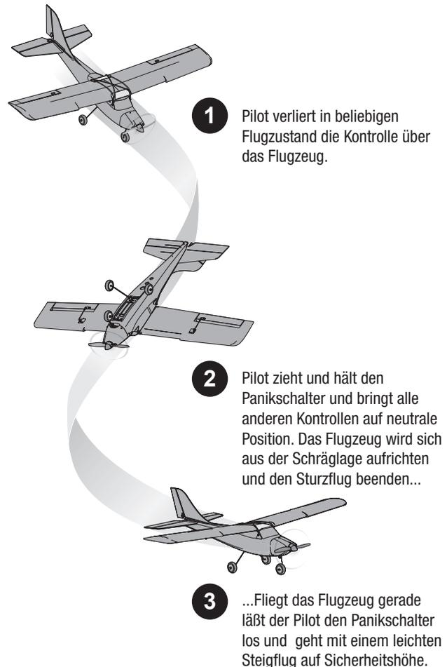
**WICHTIG:** Das Flugzeug steigt auf Sicherheitshöhe selbst wenn die Steuerknüppel gehalten werden. Selbst mit gezogenem Panikschalter wird ein kleiner Teil der Steuerbefehle noch genutzt.
