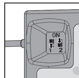
Mit dieser Einstellung können Sie mit einem 2-Positionsschalter zwischen **Anfänger- und Experten** SAFE Mode umschalten.
