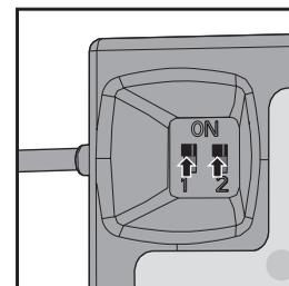
Mit dieser Einstellung können Sie mit einem 2-Positionsschalter zwischen **Anfänger- und Fortgeschritten** SAFE Mode umschalten.
