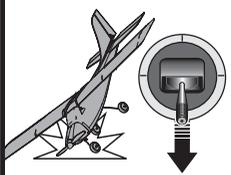
Bei Bodenberührung des Propellers sofort Gas Aus.
