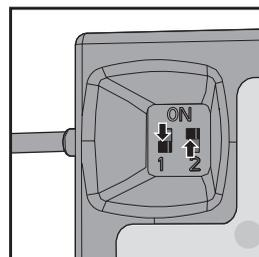
Mit dieser Einstellung können Sie mit einem 2-Positionsschalter zwischen **Fortgeschritten- und Experten** SAFE Mode umschalten.
