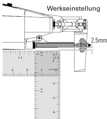
6. Messen Sie den Abstand zwischen dem unteren Lineal und der Propellerstrebe an der Stelle der Strebe die am weitesten entfernt ist.
