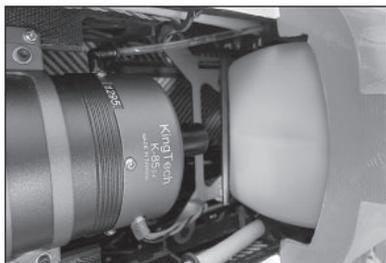
**130.** Montare la pompa del carburante nella fusoliera e collegare i tubi del carburante necessari per il funzionamento della turbina. Collegare la linea di sfiato al raccordo. Fissare tutti i collegamenti con fascette metalliche.
