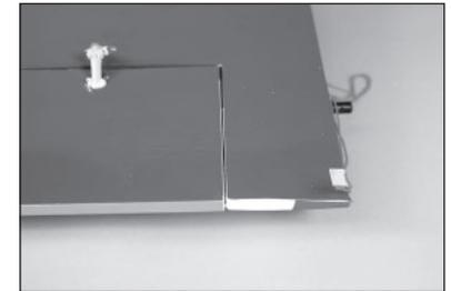
10. Utilizzare un panno di carta e alcool isopropilico per rimuovere l'eventuale colla in eccesso. Utilizzare un nastro a bassa adesione per tenere il flap in posizione fino ad asciugatura completa della colla.
