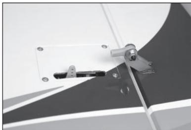
77. Assemblare il leveraggio del servo del timone. Utilizzare un'asta filettata da 35 mm e regolare il leveraggio a una lunghezza complessiva di 65 mm. Regolare la lunghezza del leveraggio come necessario per centrare il timone con il comando radio inserito.
