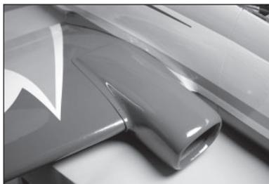
149. Utilizzare un minitrapano con punta da 1,5 mm per forare le posizioni nella presa d'aria nell'ala. Rimuovere la presa d'aria e avvitare una vite autofilettante M2 x 8 in ciascun foro. Rimuovere le viti e applicare una goccia di colla cianoacrilica fine in ciascun foro. Una volta che la colla epossidica si è completamente indurita, fissare la presa d'aria all'ala utilizzando dodici viti autofilettanti M2 x 8.
