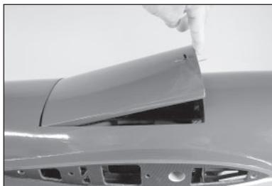
**111.** Rimuovere il portello sul parte superiore della fusoliera posteriore e metterlo da parte in un luogo sicuro.
