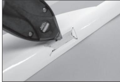
3. Controllare che le cerniere funzionino liberamente. Se le cerniere non si muovono liberamente, regolare la tensione della vite. Applicare una piccola quantità di vaselina sui punti di flessione delle cerniere per impedire che la colla penetri nelle cerniere.
