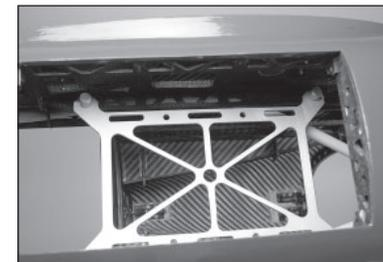
**113.** Far passare le tre fascette intorno al vassoio del serbatoio in modo da poter fissare il serbatoio al vassoio.
