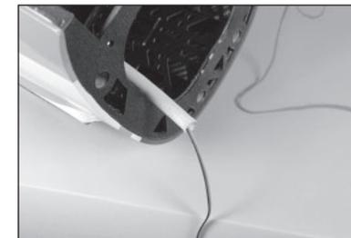
**123.** Far scorrere i manicotti per il passaggio dei servo il più indietro possibile. Segnare i manicotti sulla paratia in modo da poterne controllare il posizionamento prima di ogni sessione di volo. Utilizzare delle fascette per fissare i manicotti alla struttura sopra la posizione del tubo di spinta, in modo che non entrino in contatto con il tubo di scarico durante il funzionamento del modello.
