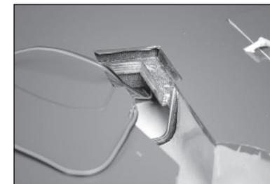
85. Recuperare i cavi dalla stessa posizione dei cavi dei flap e degli alettoni. Assicurarsi di etichettare i cavi in modo da poterli identificare al momento del montaggio del modello per il volo.
