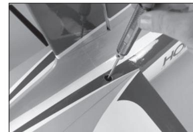
136. Inserire il gommino della vite dello stabilizzatore applicando una piccola quantità di adesivo al silicone.
