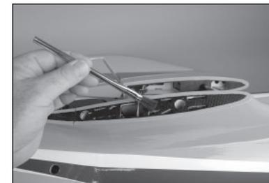
**133.** Montare l'aletta in posizione. Posizionare un piccolo pezzo di plastica nella linea di cerniera e lungo la parte inferiore del timone per evitare di incollare il timone alla fusoliera. Rimuovere la colla epossidica in eccesso con del panno di carta e alcool isopropilico.
