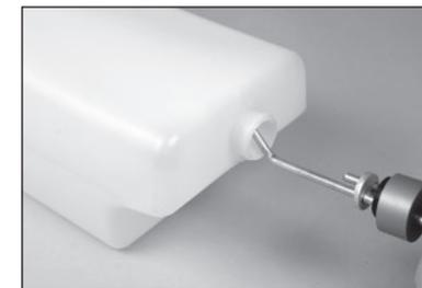
**105.** Con un saldatore e lega per saldare, creare un'area su ciascuno dei tubi (sia all'esterno che sul tubo non piegato all'interno del serbatoio) in modo da poter fissare il tubo del carburante ai tubi.
