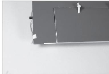
6. Rimuovere flap e cerniere. Iniettare colla epossidica in ciascuna delle tasche delle cerniere del flap.
