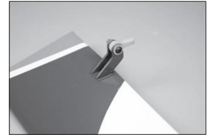
73. Quando si montano le cerniere del timone, tenere presente che la cerniera inferiore è più corta per adattarsi dietro il tubo di raccordo della deriva.
