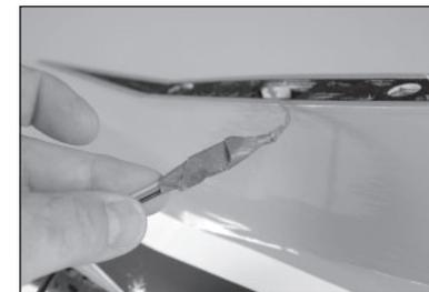
**132.** Mescolare 15 ml di colla epossidica "30 minuti". Con un pennello per colla epossidica, applicare la colla ai tubi in fusoliera per la deriva e il legno esposto.
