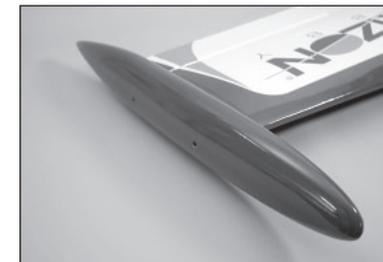
152. Con un taglierino con lama #11, rimuovere il rivestimento per l'antenna a lama VOR nella deriva. Incollare l'antenna alla deriva con utilizzando colla cianoacrilica a media viscosità. Utilizzare una squadra per assicurarsi che l'antenna sia allineata correttamente su entrambi i lati della deriva.
