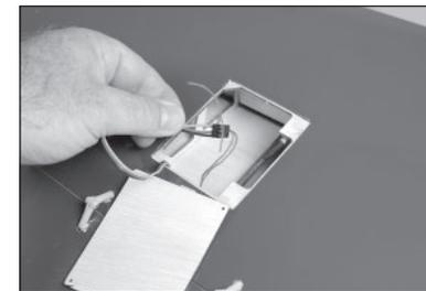
38. Con uno stuzzicadenti o un taglierino con lama n. 11, forare la copertura del servo dell'alettone per le viti di montaggio.
