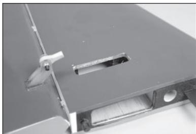
79. Montare il servo dell'equilibratore nello stabilizzatore con l'uscita del servo rivolta in avanti.
