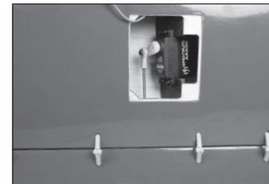
56. Tenendo il leveraggio, deflettere il flap. Con un pennarello a feltro, segnare la posizione della testa a snodo sulla parte inferiore dell'ala.
