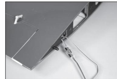
54. Centrare il servo usando il radiocomando. Posizionare il braccio del servo sul servo in modo che si trovi con una scanalatura verso il bordo d'uscita dell'ala.
