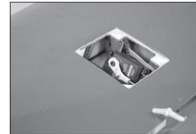
67. Fissare il coperchio del servo all'ala usando quattro viti autofilettanti M2 x 8 mm.
