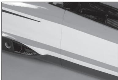
140. Fissare la sezione della fusoliera con le cinque viti preparate in precedenza. Serrare le viti con una chiave esagonale da 3 mm.
