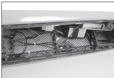
**100.** Montare un secondo ricevitore remoto nella fusoliera con del nastro a strappo. Assicurarsi che le antenne siano orientate in direzioni diverse.
