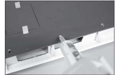
9. Posizionare le cerniere nel flap, quindi unire il flap all'ala. Controllare l'allineamento come mostrato nel passaggio 5.
