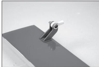
70. Utilizzare la stessa tecnica già vista per le delle cerniere dei flap per fissare le cerniere dell'equilibratore. Rimuovere dalle cerniere l'adesivo in eccesso con un panno di carta e alcol isopropilico. Utilizzare nastro a bassa adesione per tenere l'equilibratore in posizione fino ad asciugatura completa della colla.
