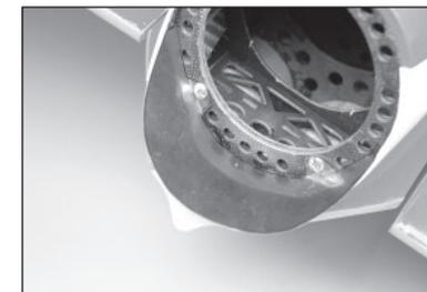
→ Il mancato montaggio della protezione dello scarico provocherà danni dovuti al calore a carico del legno e del rivestimento sopra il tubo di scarico nel retro della fusoliera.
