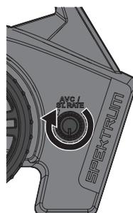
Le potentiomètre ST RATE permet de régler la sensibilité ou la valeur de stabilité du récepteur. Si vous augmentez la sensibilité, le système AVC deviendra plus sensible aux glissades vers la gauche et la droite du véhicule. Vous devrez utiliser la sensibilité maximale lors de conduite à haute vitesse ou pour effectuer des courses d'accélération en ligne droite. Plus la sensibilité est élevée, plus le débattement de la direction est faible.
