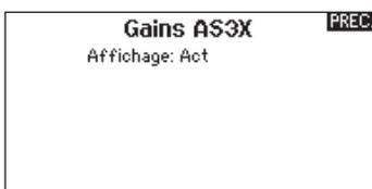
2. Entrez dans le menu des gains de l'AS3X dans la liste des fonctions. Si un récepteur AS3X est affecté à l'émetteur et qu'il est alimenté, les valeurs des gains vont s'afficher en temps réel à cet écran.
