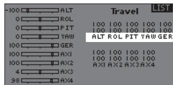
**IMPORTANT :** ALT, ROL, PIT et YAW remplacent les voies THR, AIL, ELE et RUD pour les multi-rotors pour mieux correspondre aux axes de vol d'un multi-rotor. Ce changement est effectif dans l'intégralité des options menu d'un multi-rotor.
