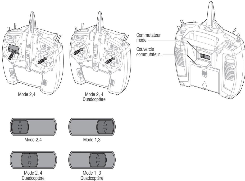
Ouvrez simplement le couvercle de protection du commutateur et placez le commutateur à la position désirée. Tout changement sera pris en compte automatiquement par l'émetteur.
