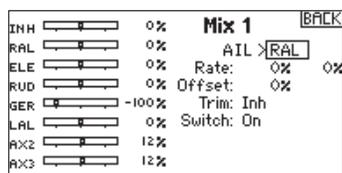
**IMPORTANT :** Assurez-vous que l'aileron droit est bien relié au port AIL du récepteur et l'aileron gauche est bien relié au port Aux1 du récepteur.
