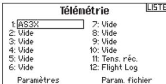
1. Entrez dans le menu Télémetrie depuis La Liste des Fonctions ou depuis les Paramètres Système. Sélectionnez la voie "libre" désirée pour le réglage du gain. Appuyez sur la roulette et faites tourner jusqu'à AS3X. Le menu de Gains AS3X est maintenant disponible dans la Liste des Fonctions.
