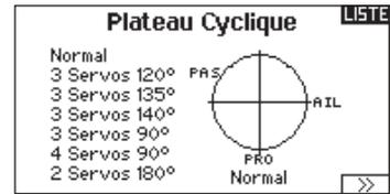
Activez toujours les Expos quand vous utilisez des servos standards rotatifs. L'Expo délivre un mouvement linéaire du plateau à partir du mouvement rotatif des servos standards. Si l'Expo n'est pas activé, le bras du servo va avoir un mouvement courbe qui diminuera la course du plateau aux extrémités de la course du bras.
