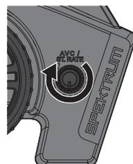
Faites tourner le potentiomètre ST RATE dans le sens anti-horaire pour réduire la sensibilité.
