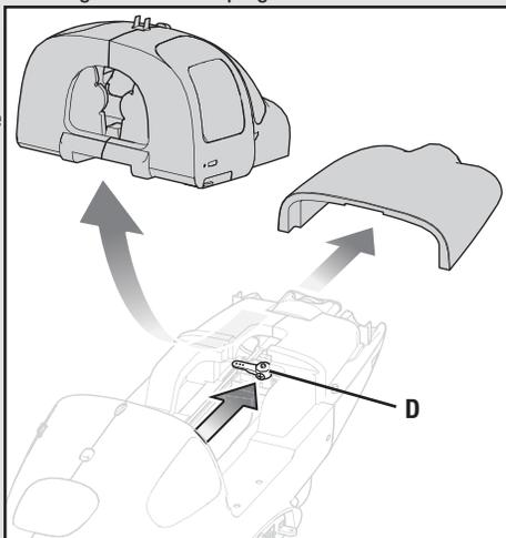
5. Serrez la vis de 3 x 8 mm dans le bras de commande du train avant (**D**) de manière à ce qu'il agrippe le support du train avant sur sa partie plate.
